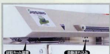
自動送り込み、材料カット装置付
