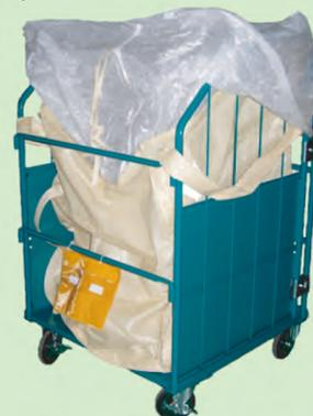
⑥フレコンバッグのフタを折り曲げて固定紐をステーに縛り完了です。
